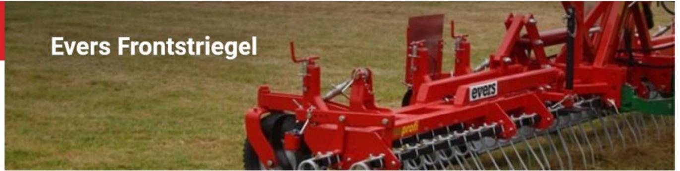
Mit dem Frontstriegel werden zwei Bearbeitungen in einem Arbeitsgang durchgeführt: Einebnen und Eggen. Der Einebnungsbalken ebnet den Boden und die zwei Reihen mit schweren Eggenzinken bearbeiten die Grasnarbe intensiv.
